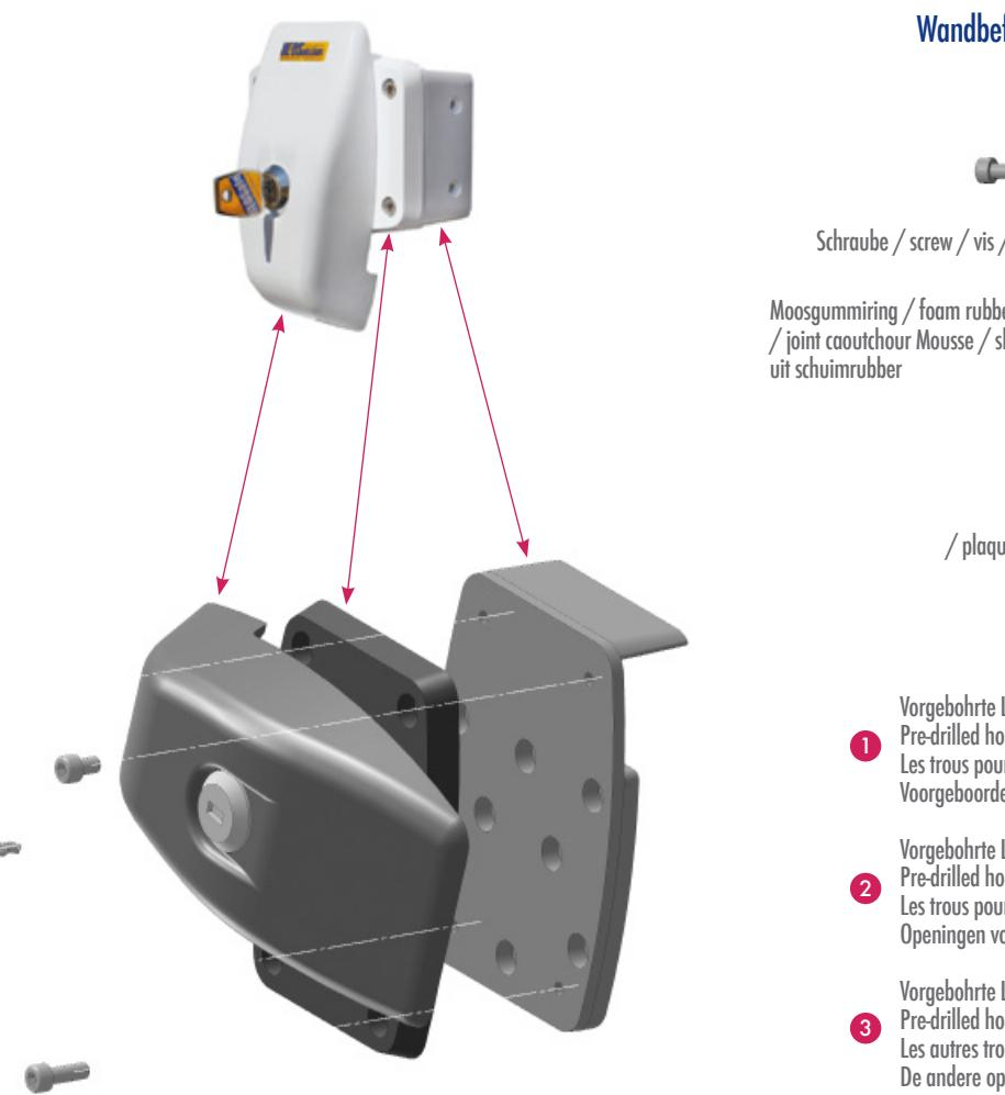
**Wandbefestigung / Frame mounting / Montage sur l'encadrement / Montage of the bevestigingsplaat**
