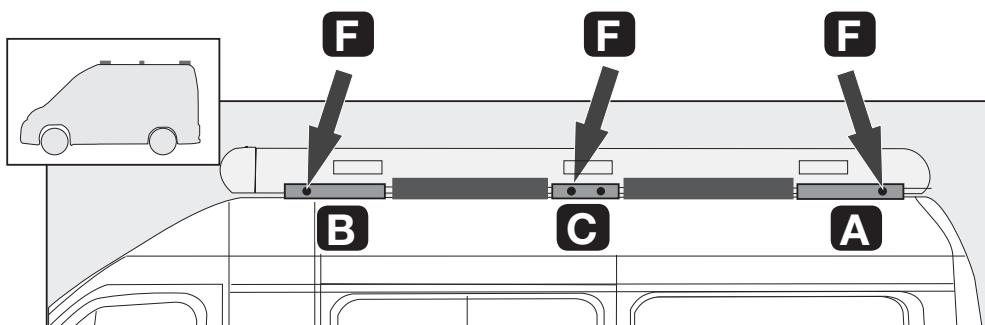
**DE** **ACHTUNG:** regelmäßig die Befestigung der Halterungen kontrollieren. Achten Sie vor allem nach dem ersten Sicherstellen darauf, dass sich die Haltebügel nicht verschoben haben.
