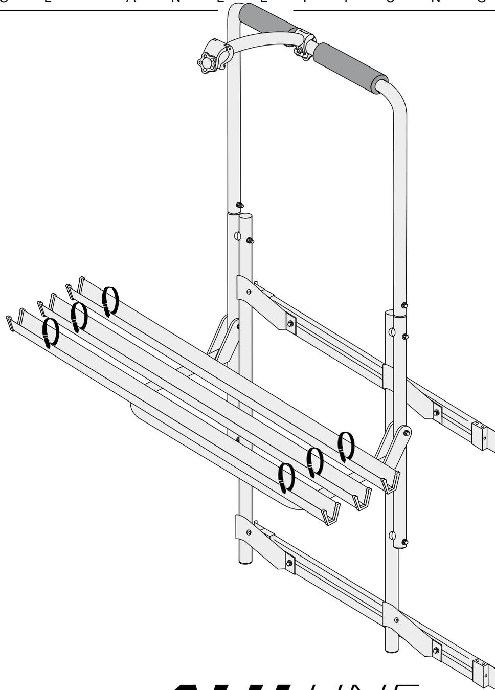
Der EURO-CARRY ist ein Spezialträger aus Aluminium. Er wird an der rechten Hecktüre mit wenigen Handgriffen montiert. Serienmäßig ist der EURO-CARRY mit 2 Fahrradschienen zur Aufnahme der Fahrräder ausgerüstet und kann mit einer zusätzlichen Schiene und Befestigungskralle für 3 Fahrräder erweitert werden.
