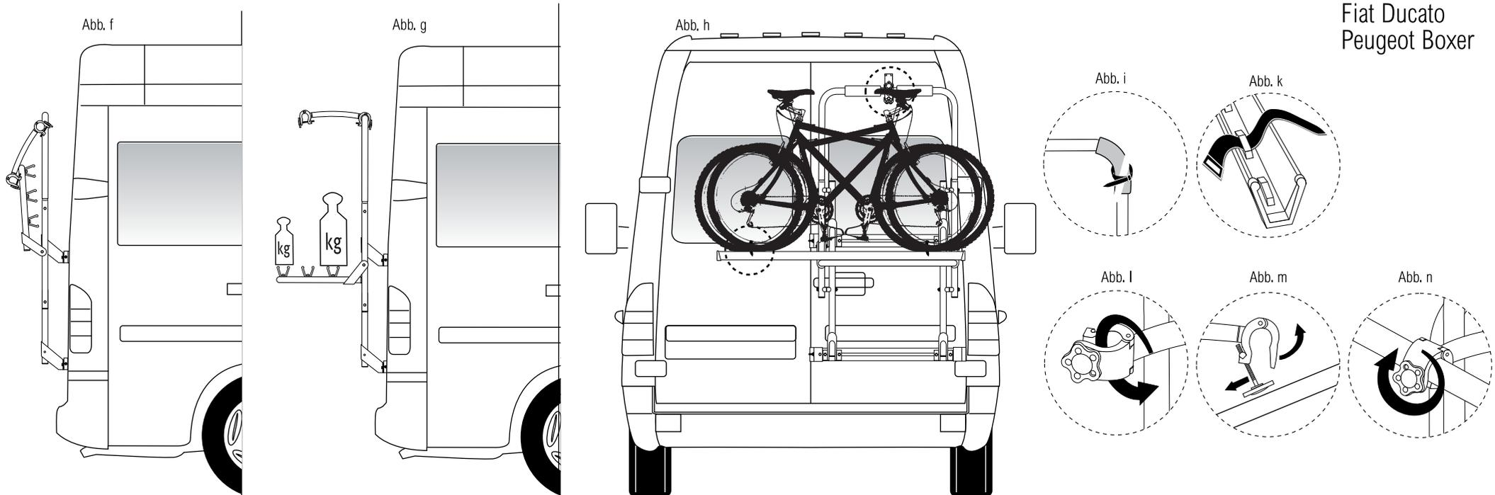
Der Schienenträger (4) des EURO-CARRY lässt sich in unbeladenem Zustand hochklappen. Mit einem Zurr-Riemen (13) bitte extra sichern. Zusätzlich kann die Befestigungskralle heruntergeklappt werden (Abb.f).
